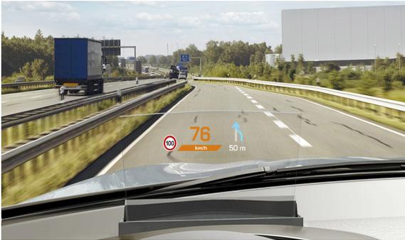
**Abb. 3-3** Head-up Display im Cockpit eines Autos (Continental 2016)
