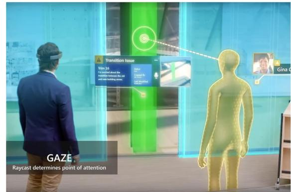
**Abb. 3-8** Gaze auf der HoloLens - Selektion mit dem Blick (Microsoft HoloLens 2016)
