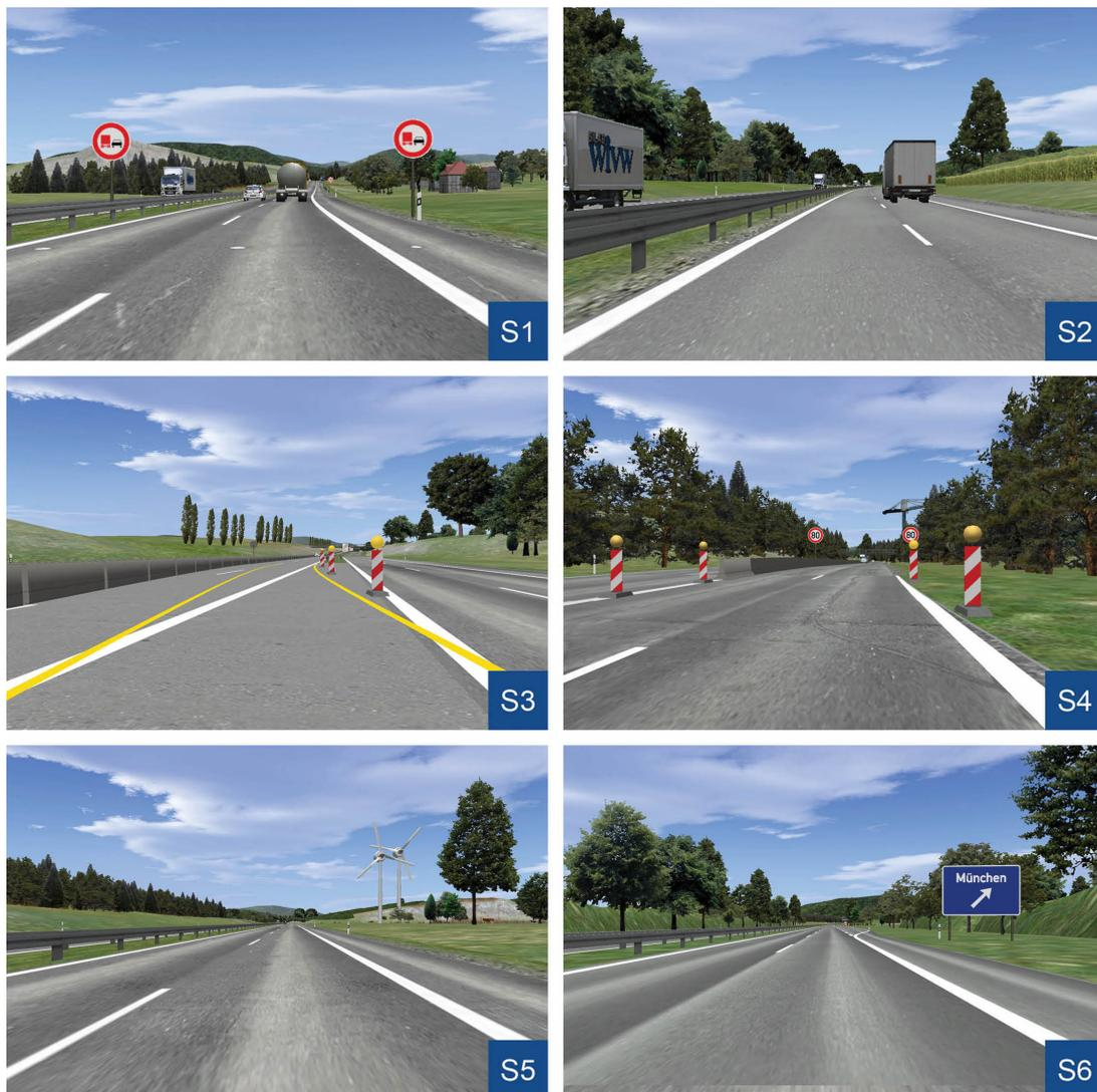
Abbildung 4.3: Überblick zu den sechs Szenarien in der Fahrsimulation v. l. n. r.: Freie Fahrt mit anschließender Folgefahrt (S1), Überholmanöver (S2), Baustelle (S3), fehlende Fahrbahnmarkierungen (S4), Freie Fahrt mit Sensorausfall (S5), Autobahnabfahrt (S6).
