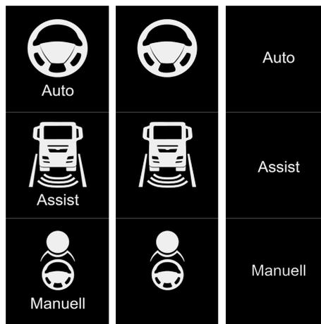
Abbildung 4.6: Gestaltungsvarianten des Statusindikators: Symbole + Text (links), nur Symbole (mittig), nur Text (rechts).
