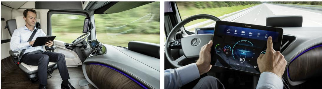
Abbildung 2.14: Daimler – Mercedes-Benz Future Truck 2025 [90]: Fahrerkabine mit gedrehtem Fahrerstuhl (links), Anzeige im Tablet (rechts).
