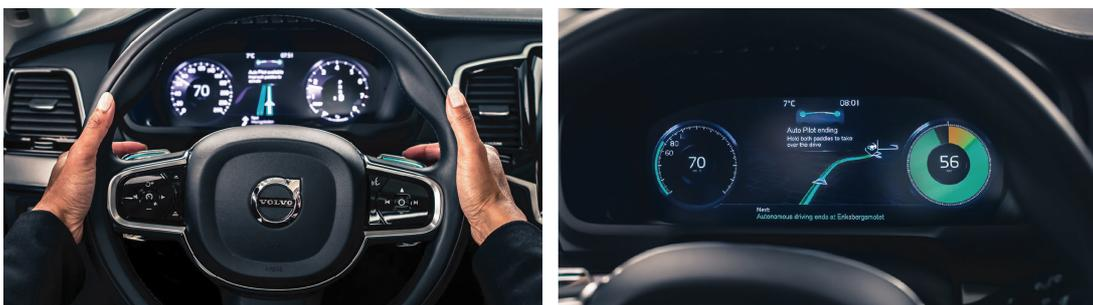
Abbildung 2.10: Konzept für das HAF von Volvo [77]: De-/Aktivierung des HAF-Modus erfolgt über Wippschalter (links), im Kombidisplay wird während der hochautomatisierten Fahrt und bei Übernahmeaufforderungen eine Karte sowie ein Timer zur verbleibenden HAF-Verfügbarkeit angezeigt (rechts).
