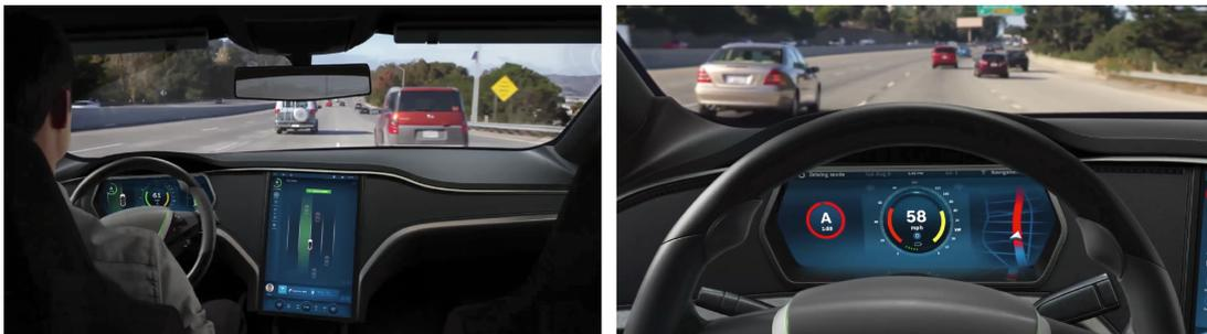
Abbildung 2.11: Konzept von Bosch Mobility Solutions [78]: Hochautomatisierte Fahrt mit Manöveranzeige im Infotainmentdisplay (links), Übernahmeaufforderung (rechts).
