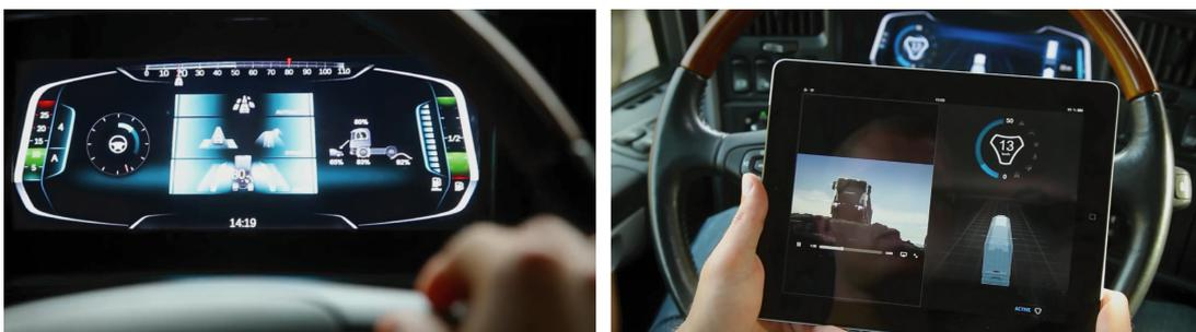
Abbildung 2.13: Scania Active Frame Konzept [81]: Kombidisplay mit dreistufigem Statusindikator (links), geteilte Ansicht auf dem Active Frame Tablet (rechts).
