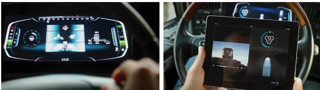
Abbildung 2.13: Scania Active Frame Konzept [81]: Kombidisplay mit dreistufigem Statusindikator (links), geteilte Ansicht auf dem Active Frame Tablet (rechts).
