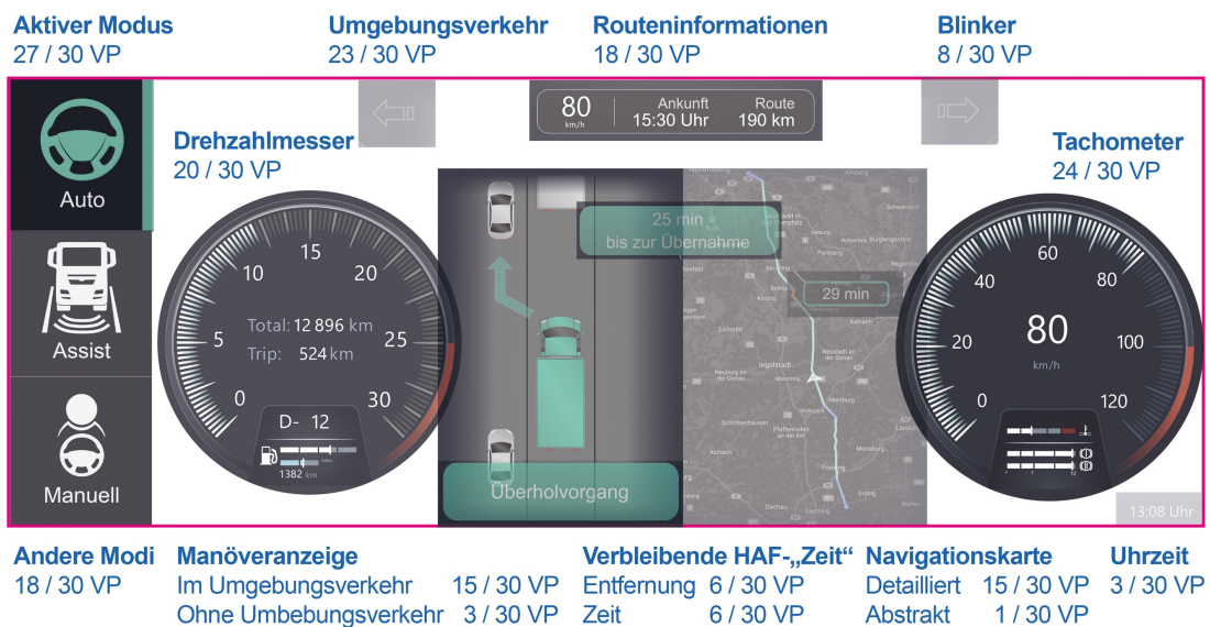
Abbildung 5.27: Mix and Match – Kombiinstrument im „Alles in Ordnung“-HAF-Modus: Absolute Auswahlhäufigkeiten der jeweiligen Elemente.
