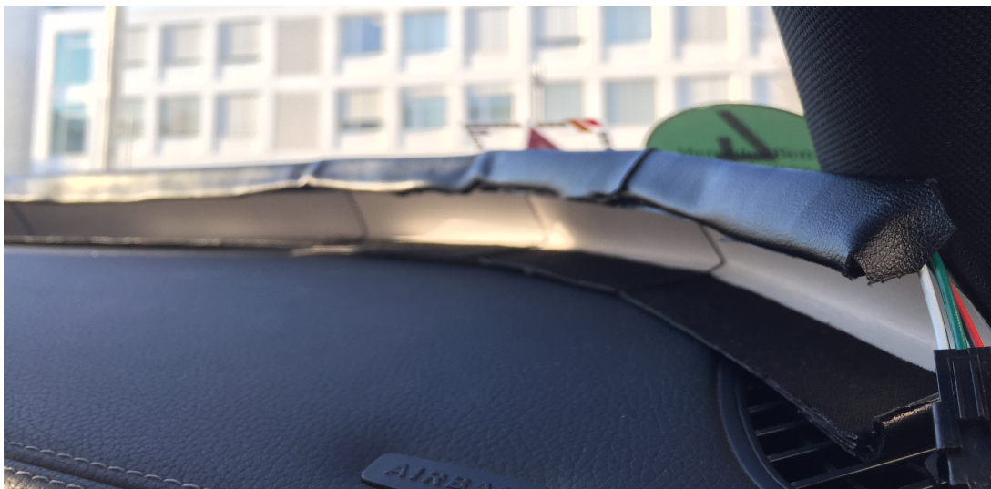
Abbildung C.2: Die nach dem Konzept aus Abbildung C.1 prototypisch eingebaute LED-Halterung in einem Fahrzeug-Cockpit [121, S. 37].
