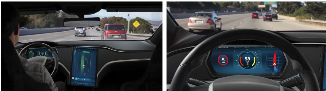
Abbildung 2.11: Konzept von Bosch Mobility Solutions [78]: Hochautomatisierte Fahrt mit Manöveranzeige im Infotainmentdisplay (links), Übernahmeaufforderung (rechts).
