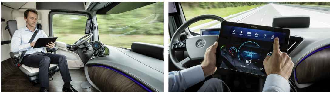
Abbildung 2.14: Daimler – Mercedes-Benz Future Truck 2025 [90]: Fahrerkabine mit gedrehtem Fahrerstuhl (links), Anzeige im Tablet (rechts).
