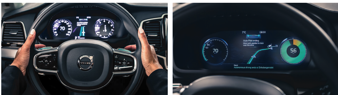
Abbildung 2.10: Konzept für das HAF von Volvo [77]: De-/Aktivierung des HAF-Modus erfolgt über Wippschalter (links), im Kombidisplay wird während der hochautomatisierten Fahrt und bei Übernahmeaufforderungen eine Karte sowie ein Timer zur verbleibenden HAF-Verfügbarkeit angezeigt (rechts).
