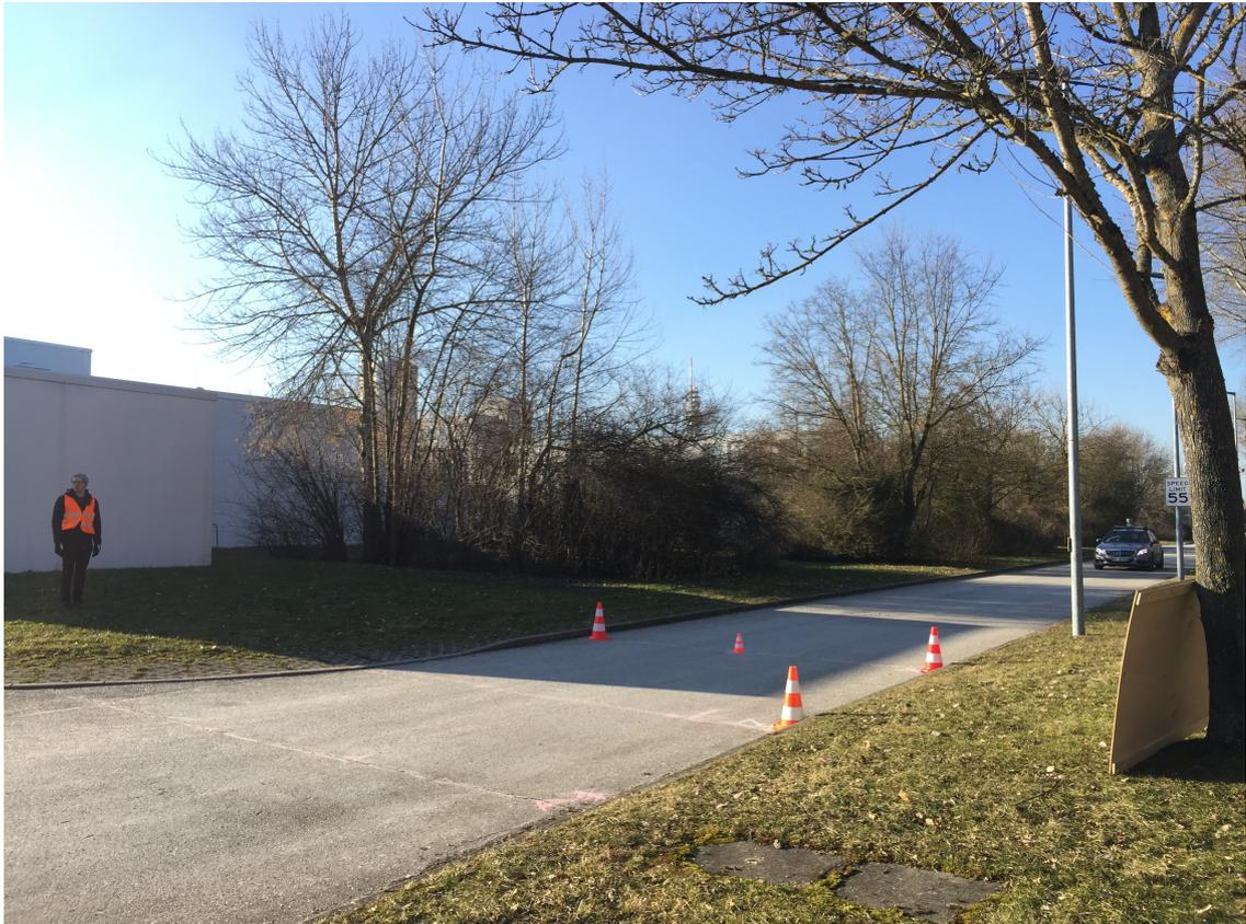
**Abbildung 18** Foto eines Versuchsaufbaus. Zu sehen sind Kreidemarkierungen und Pylonen zur Markierung der Halte- und Lauflinien. Rechts im Bild ist die Spanplatte zu erkennen, hinter der der Co-Statist aufgestellt ist.
