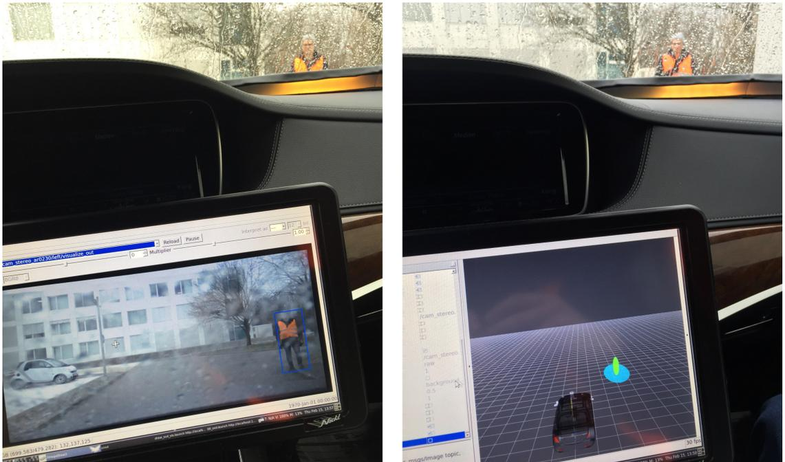
**Abbildung 15** Darstellung eines über das Umgebungserfassungssystem erkannten VRU mit Bounding Box im Kamerabild (links) und als Repräsentation im dreidimensionalen Raum (rechts)
