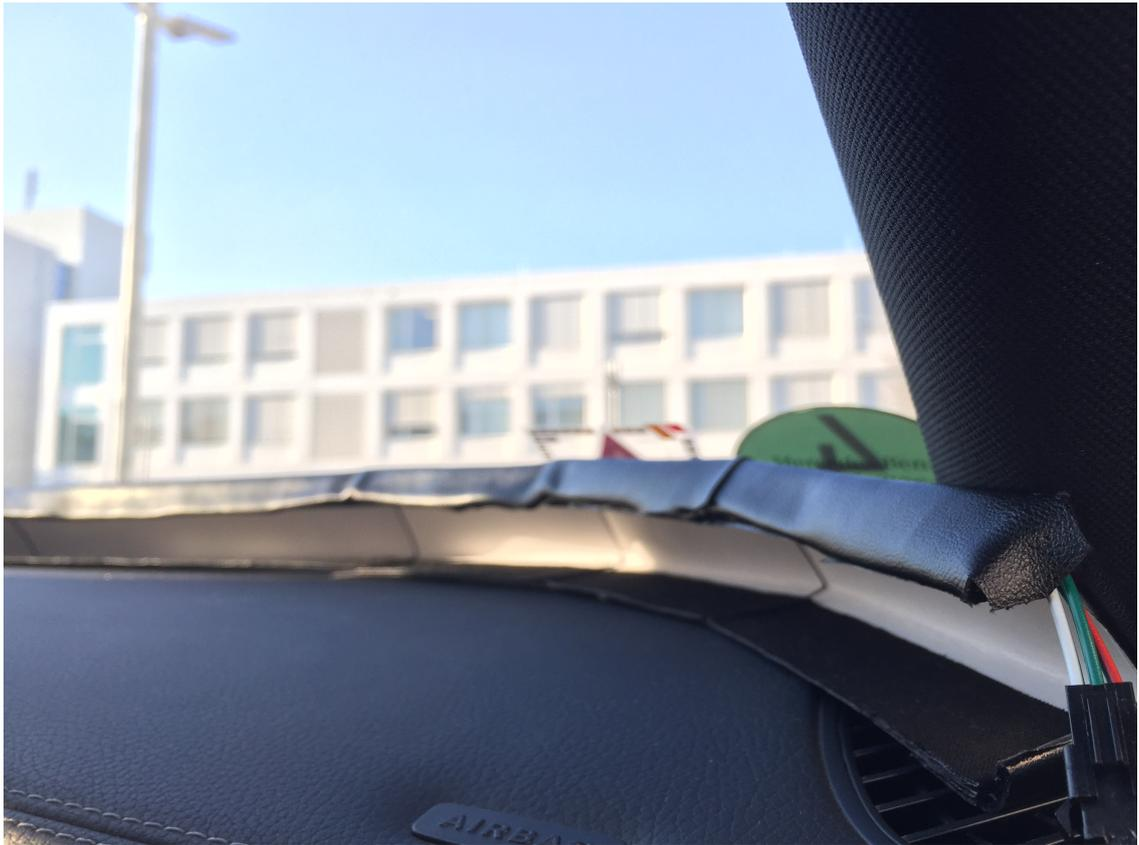
**Abbildung 13** Die eingebaute LED-Halterung im Fahrzeug
